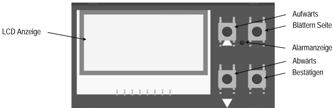
Abbildung 35: Bedienelemente der Kommunikationsbox (DIN)
