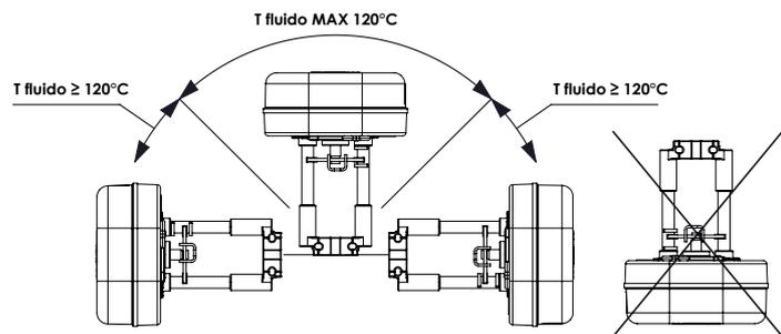
Per montare il servocomando sulla valvola, posizionare lo stelo a fine corsa, far scivolare il servocomando sul collo della valvola; sistemare con il comando manuale la posizione della vite così che il dado quadro posto sullo stelo della valvola si adatti perfettamente all'incavo posto sulla piastrina trasversale. Far scorrere la forcella ad U nell'incavo del collo della valvola e fissarlo con i dadi.
