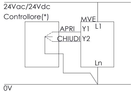
**Comando flottante a 3 punti (connessione source)**
