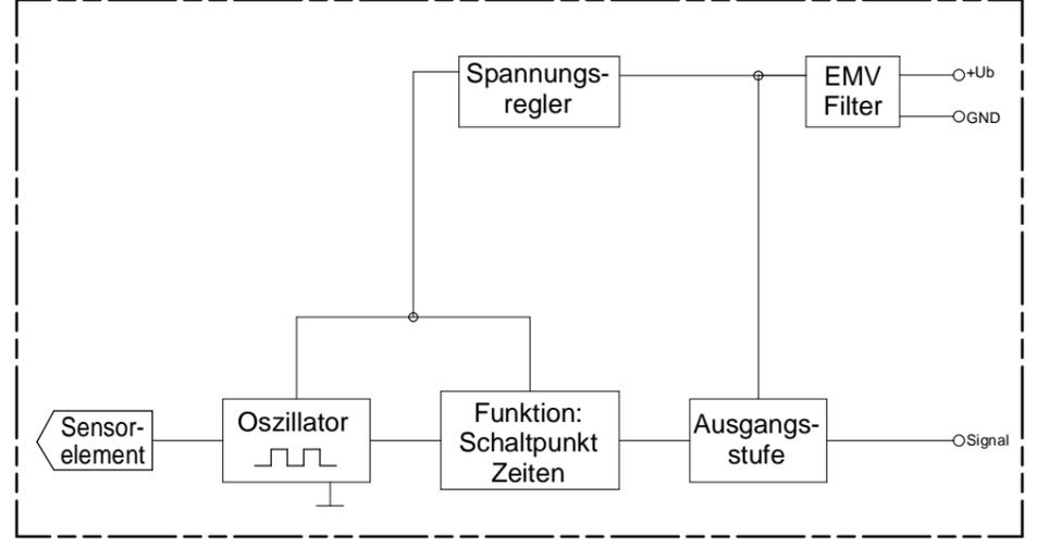
**Funktionsdiagramm für MINIMUM Sonden**
