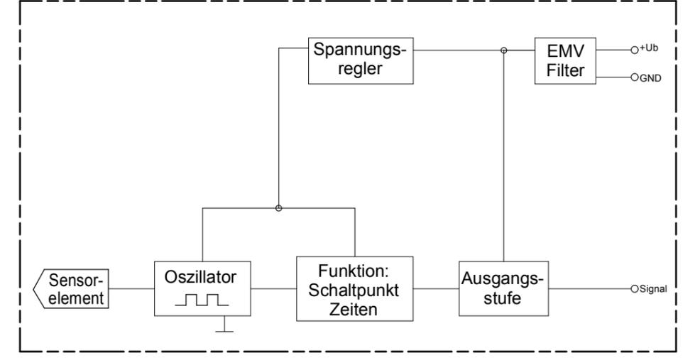
**Funktionsdiagramm für MINIMUM Sonden**
