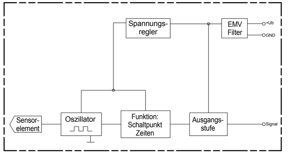
Funktionsdiagramm für MINIMUM Sonden
